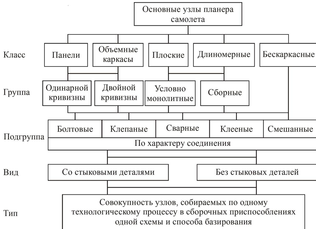
Рис. 25.1. Принципиальная схема классификации основных узлов планера самолета
