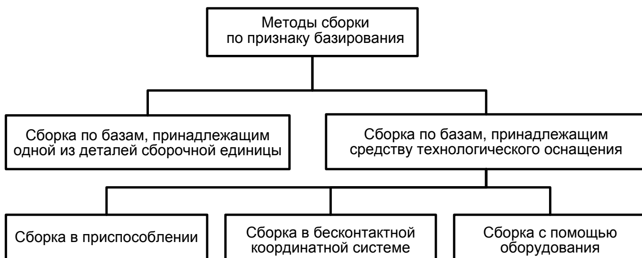
Рис. 1.2. Классификация методов сборки по признаку базирования
