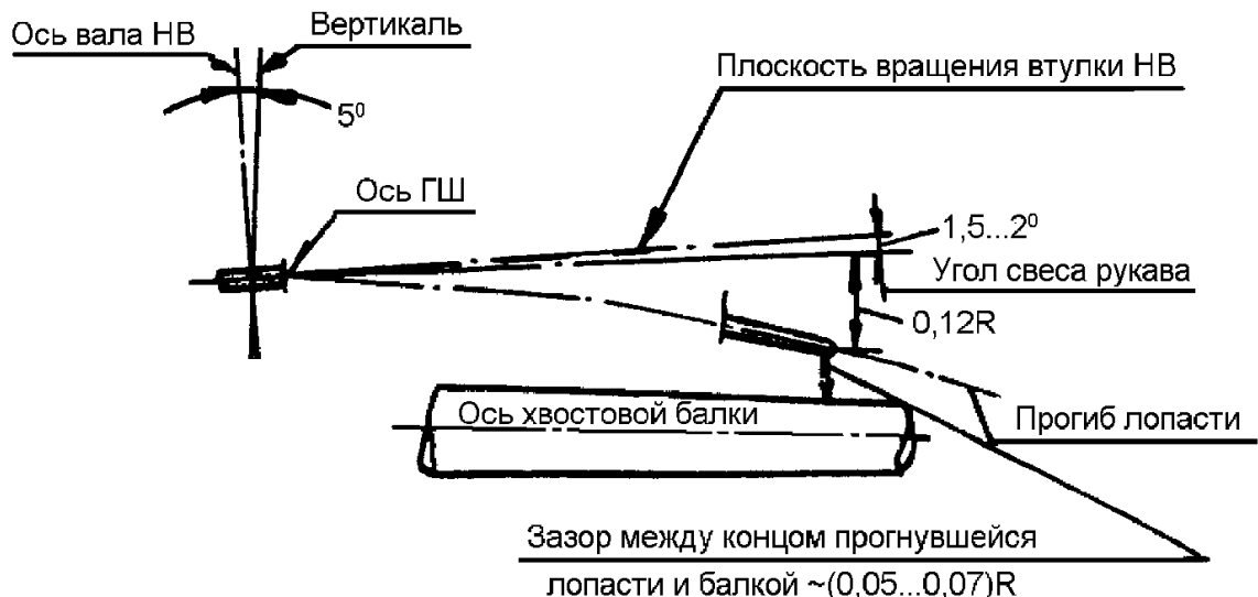
Рис. 3. Розташування втулки НГ над фюзеляжем
