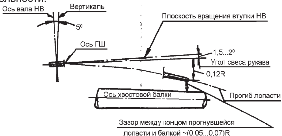
Рис. 2. Расположение втулки НВ над фюзеляжем
