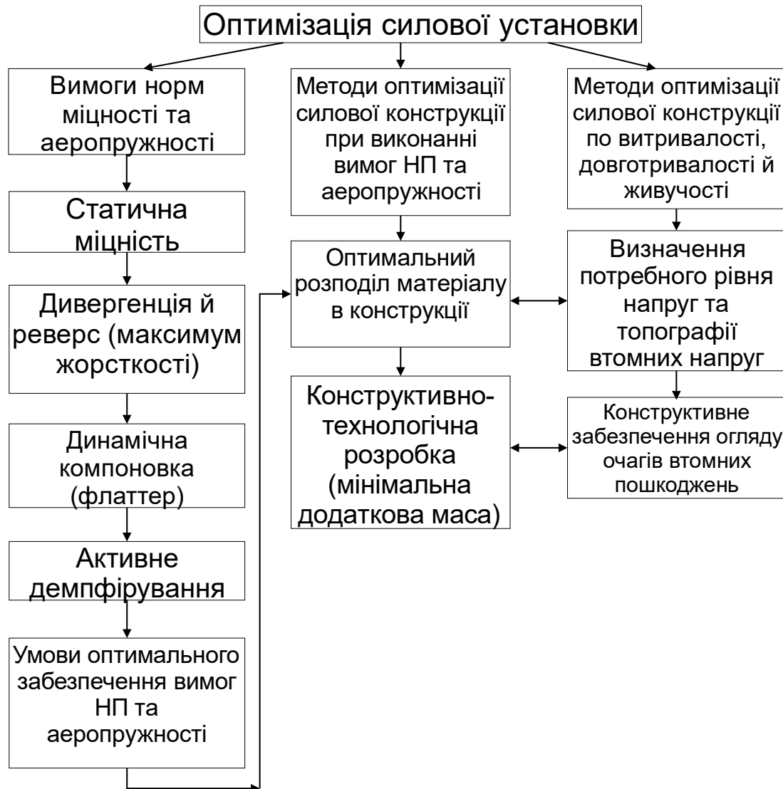
Схема оптимізації силової конструкції літака
