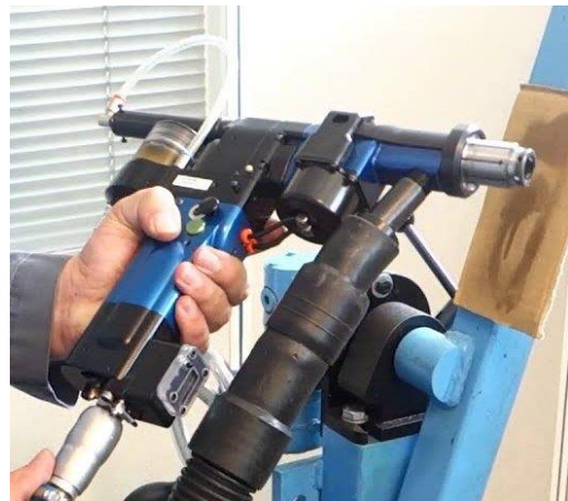
Рис. 11.10. Компонувальна схема (а) та загальний вигляд (б) СМАП моделі ST1200: 1- вібратор; 2 - маслянка; 3 - регулятор частоти обертання; 4 - патрон із щілинною насадкою; 5 - штуцер витяжної вентиляції; 6 - регулятор подачі; 7 - пускова кнопка; 8 - блок пневматичної турбіни; 9 - кнопка аварійної зупинки; 10 - регулятор кількості циклів обробки; 11 - штуцер пневматичної мережі
