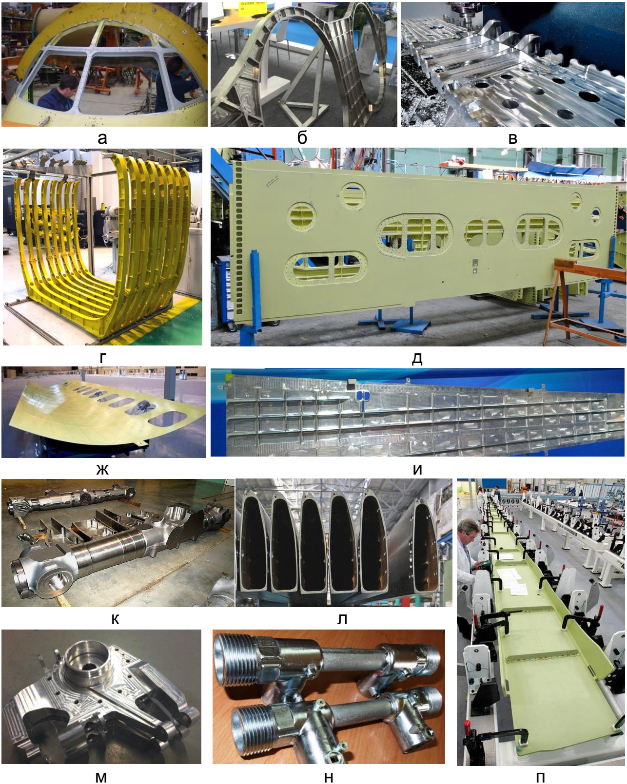
Рис.1.2. Приклади деталей планера ЛА, що оброблюються з видаленням зайвого матеріалу: а - каркас ліхтаря кабіни пасажирського літака; б - монолітний шпангоут винищувача; в - силова нервюра крила; г - збірно-монолітний шпангоут вертольота; д - панель центроплану пасажирського літака; ж - листова обшивка фюзеляжу; и - панель крила; к - носова стійка шасі пасажирського літака; л - лонжерон лопаті несучого гвинта вертольота; м - кронштейн; н - штуцер; п - лонжерон крила аеробуса
