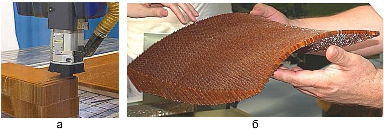
Рис. 14.29. Загальний вигляд приймача стружки та пилу із зони фрезерування (а) та стільникового заповнювача з полімерсотопласту після фрезерування (б)
