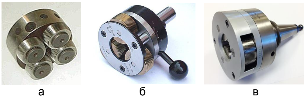
Рис. 10.14. Роликові головки з патронним (а), цанговим (б) і конусним (в) кріпленням на токарних верстатах
