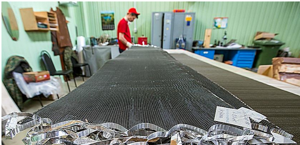
Рис. 13.5. Схема приклеювання тканини до заготовки (а) та загальний вигляд стільникового блоку після розтягування пакета (б); 1 – ложемент; 2 – вантаж; 3 – стільниковий пакет; 4 – стрічка
