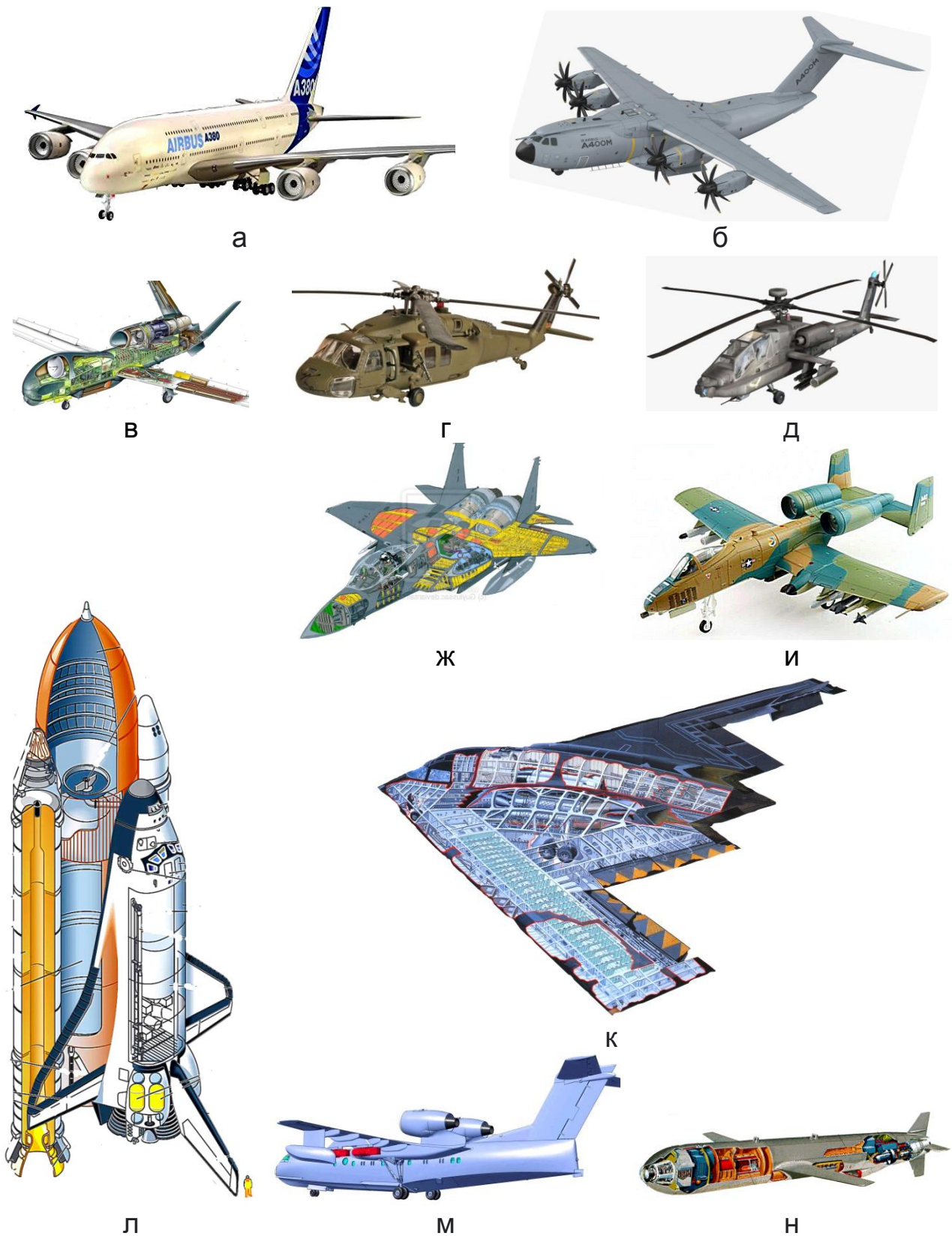
Рис.1.1. Компонувальні схеми деяких сучасних ЛА: а – пасажирський літак -аеробус; б - важкий транспортний літак; в – безпілотник; г - багатоцільовий вертоліт; д - бойовий вертоліт; ж - надзвуковий винищувач; и - штурмовик; к - малопомітний стратегічний бомбардувальник; л - ракетно-космічна система; м - гідролітак; н - крилата ракета
